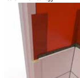
Försegling på karm Skyddar väggens inre konstruktion
