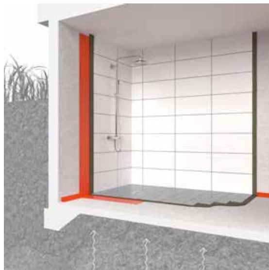
Källare med tillskjutande markfukt.
